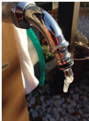
2016年1月25日9時2分 高知県香南市 「水道の蛇口の中の部分が凍って 押し出されてるー！」
